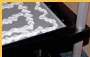
Je nach Befüllung der tragenden Ebenen verändert sich der Klang. Dabei war sogar zu hören, ob das Sand/Stahlkugel-Gemisch in der Tüte blieb (l.) oder ausgeschüttet wurde (M.). Rechts mit „Terostat“
